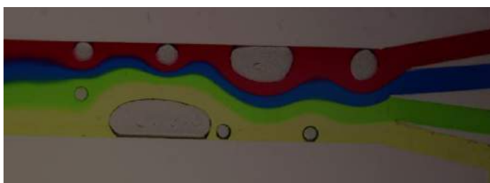
Des bulles d'air dans le canal principal...
