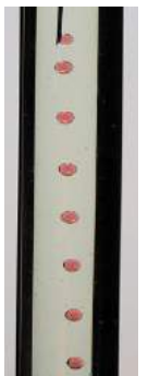
Gouttes "elliptiques" générées par un pousse-seringue, en mouvement dans un tube à essais rempli d'huile
